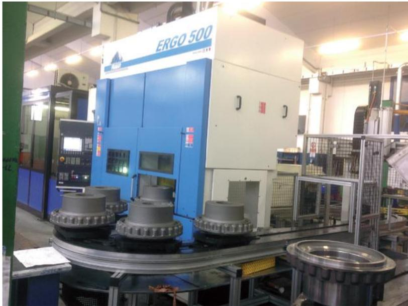
**Fig. 3** - Torno verticale per la lavorazione di grossi mozzi per macchine per movimento terra, alimentato da un caricatore automatico.
