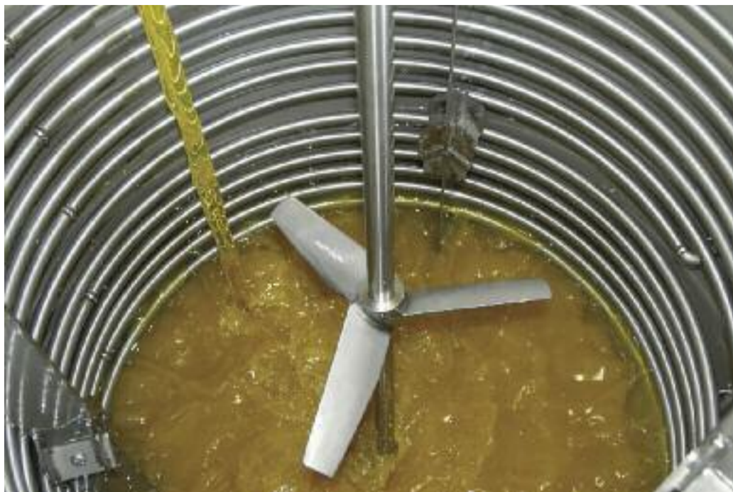
L'immagine illustra il processo produttivo. Le materie prime vengono immesse in miscelatori con una capacità produttiva massima di 7000 l
