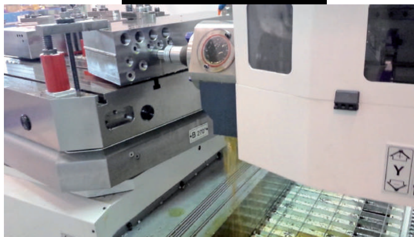
A sinistra: Dettaglio fase di filettatura su centro di foratura profonda e fresatura MF1250/2FL collaudato a luglio con lubrorefrigeranti Harolbio di Bellini.
