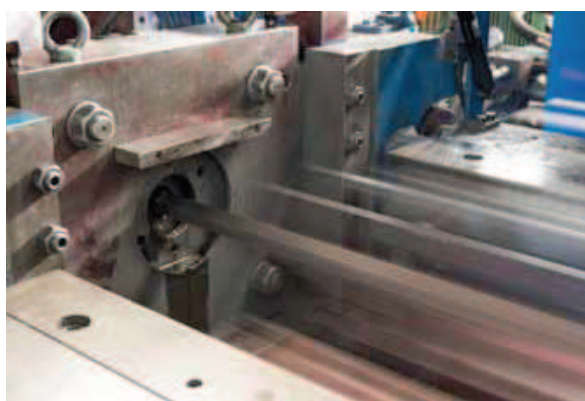
Dettaglio del processo di trafilatura in MAB
