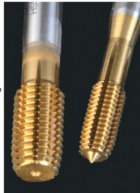
Fig. 3 – Maschi rullatori con scanalature di lubrificazione ricoperti con TiN.
