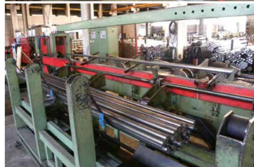
Lubrificante X-draw 220 XP di Bellini Lubrificanti nella fase di trafilatura di barre tonde.
