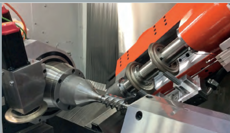
Rettifica per rotori con due mole CBN per sgrossatura e finitura.
